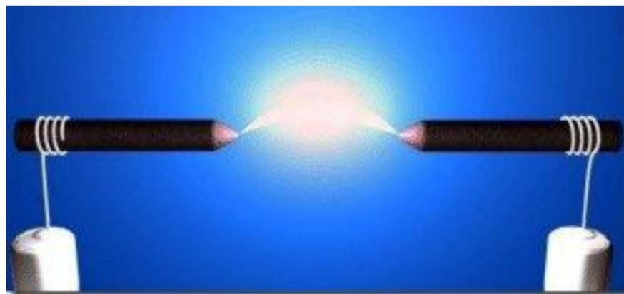
Angl. [voltaic arc, electric arc](#); kr. [вольтова дуга, электрическая дуга](#)
