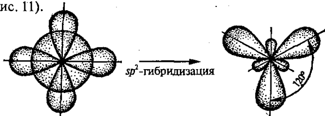
Рис. 11. Образование гибридных sp^2 -орбиталей в атоме бора
